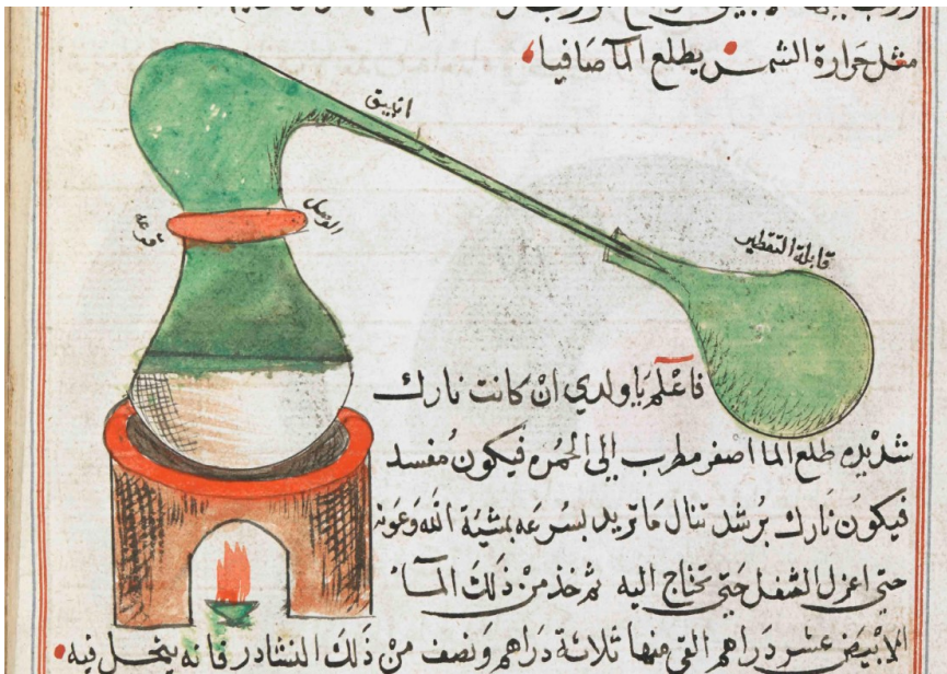
Fig. 2a. Alambic sur fourneau. Manuscript Londres, British Library, Add. 25724, f. 36v. Le joint en lut est mis en évidence, il s'agit du bourrelet rouge qui fait la jointure entre la cucurbitte et l'alambic. Il est décrit à droite du bourrelet : al-waṣl en arabe, c'est-à-dire « le joint ».
