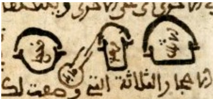
Fig. 16. Appareil des deux bols ( qadahān ), alambic, aludel à couvercle tronconique amovible. Manuscrit Rabāt, Hasaniyya 1393, f. 153r.
