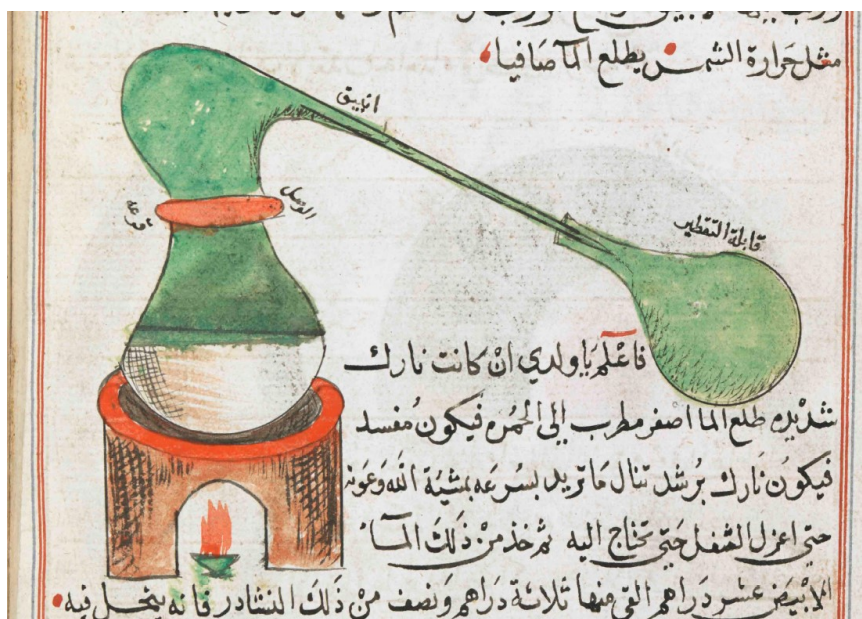
Fig. 2a. Alambic sur fourneau. Manuscrit Londres, British Library, Add. 25724, f. 36v. Le joint en lut est mis en évidence, il s'agit du bourrelet rouge qui fait la jointure entre la cucurbitte et l'alambic. Il est décrit à droite du bourrelet : al-waṣl en arabe, c'est-à-dire « le joint ».
